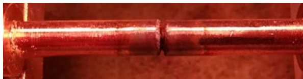
Abb. 8: Planes Kupferelektrodenpaar vor (oben) und nach (unten) einer Beanspruchung mit 300 Vdc/ 150 Adc, Abstand d = 0,8 \text{ mm} , verschweißt
