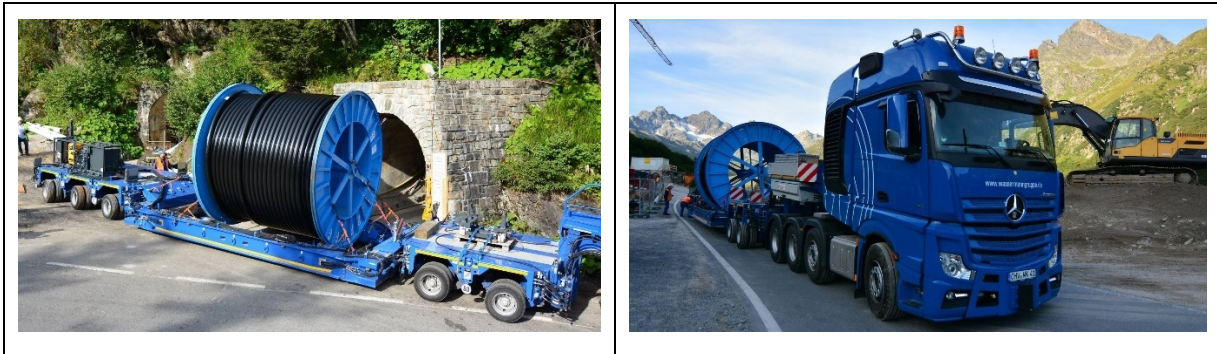
Abbildung: Transportfahrzeug mit Kabeltrommel auf Spezialplattform, Achse in Fahrtrichtung transportiert (Quelle: Fa. Wassermann Kabeltechnik)
