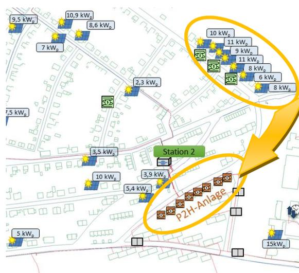
**Abbildung 14: Sektorkopplung mittels P2H-Anlage zur Speicherung von Überschussstrom**
