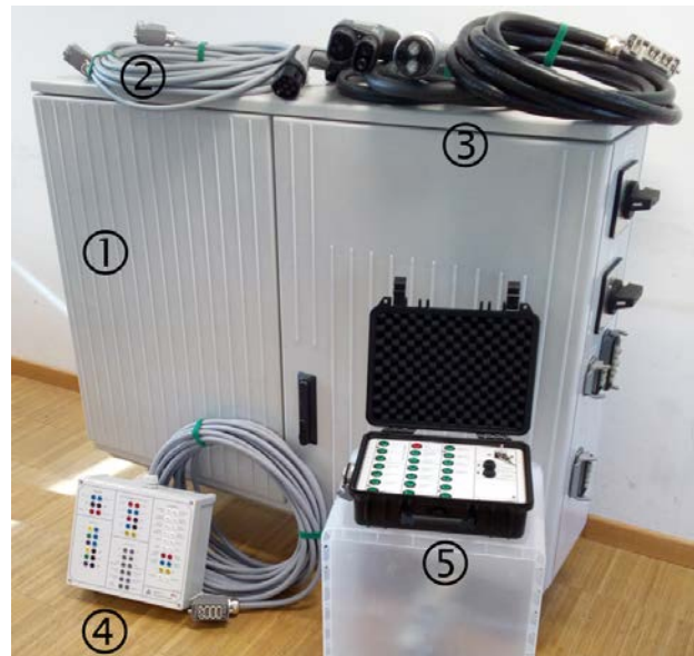
Abbildung 1: Messverteiler ① samt Zubehör (Fernbedienungssteuerleitung ②, Ladeleitungs-garnituren ③, Messbox ④, Fernbedienung ⑤)
